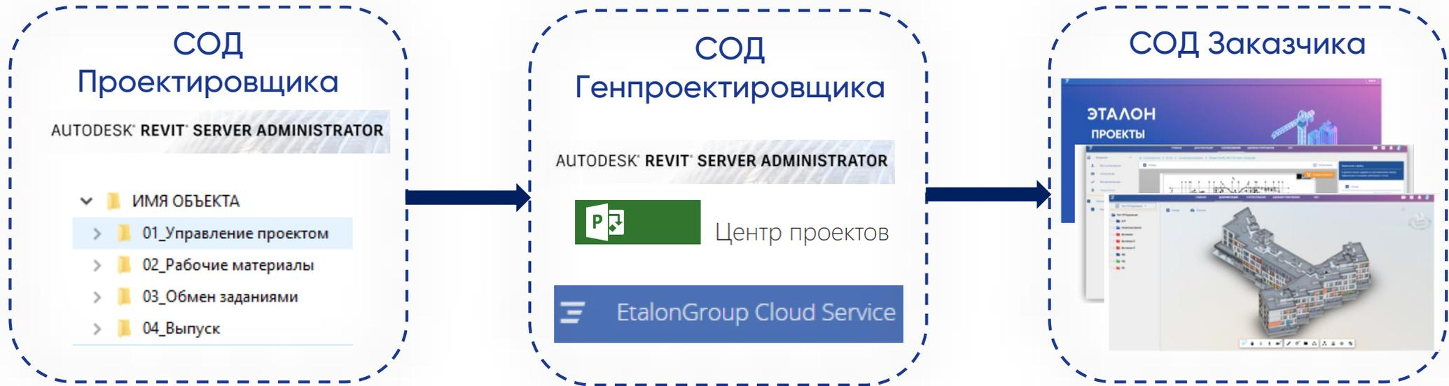
Необходима для обеспечения рабочего процесса проектирования: хранение и распространение стандартных библиотек компонентов, решений, хранение и распространение исходно-разрешительной документации, обмен заданиями, хранение графика проектирования.
