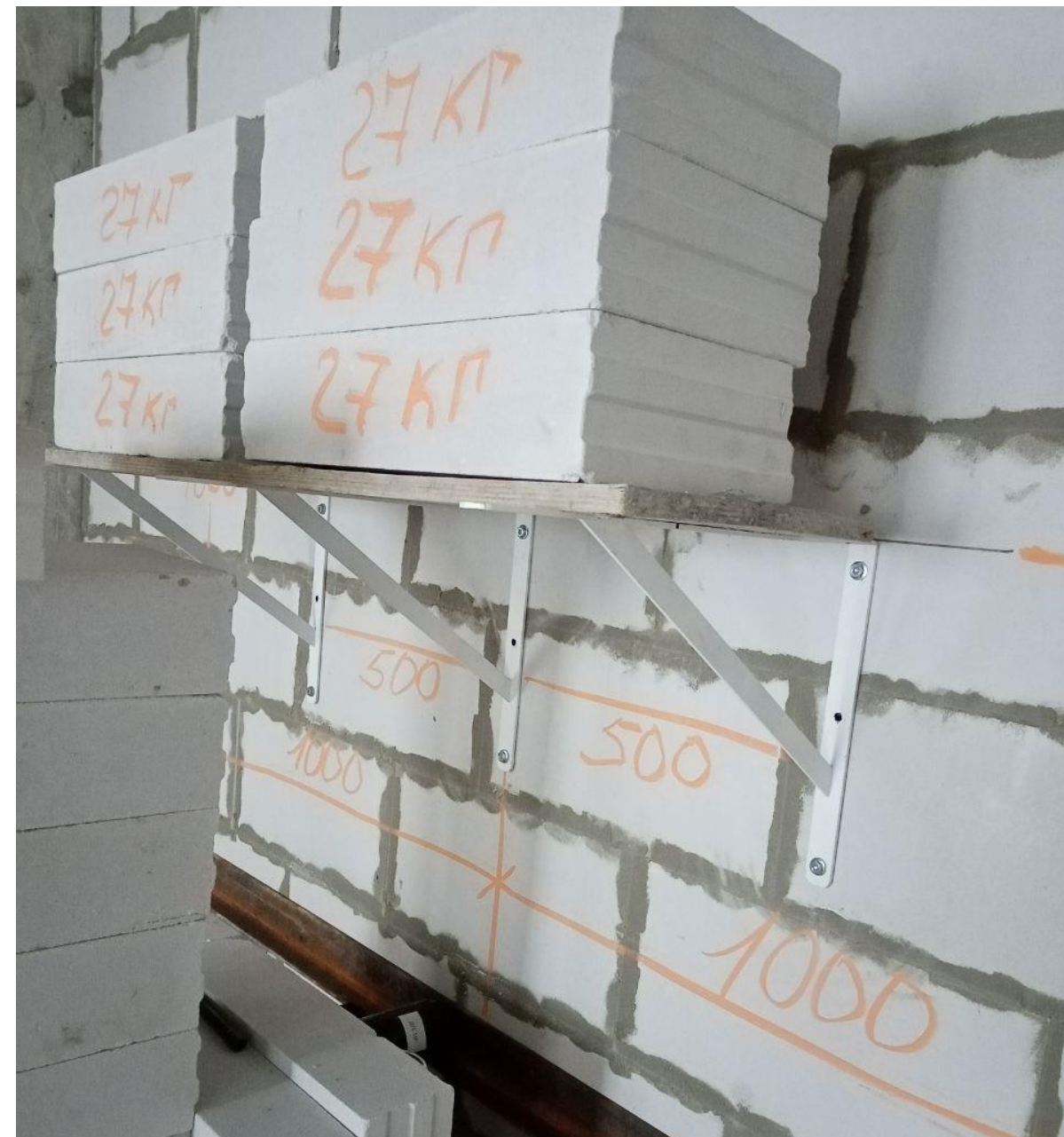
Моделирование эксплуатационных нагрузок. Пример: шкафы и ветровая нагрузка
