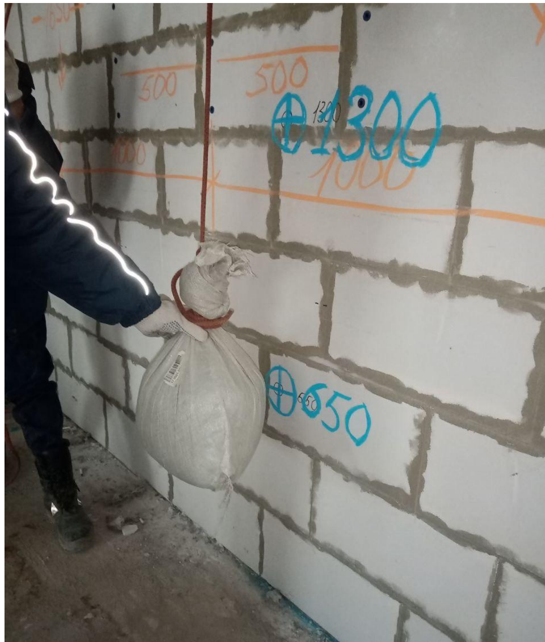
Динамические испытания конструкции стены. Удар глухим предметом весом 30 кг с разной высоты.
